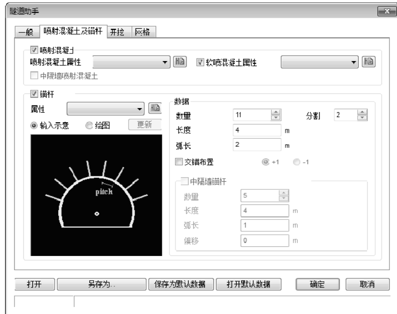
图 5-100 喷射混凝土及锚杆
